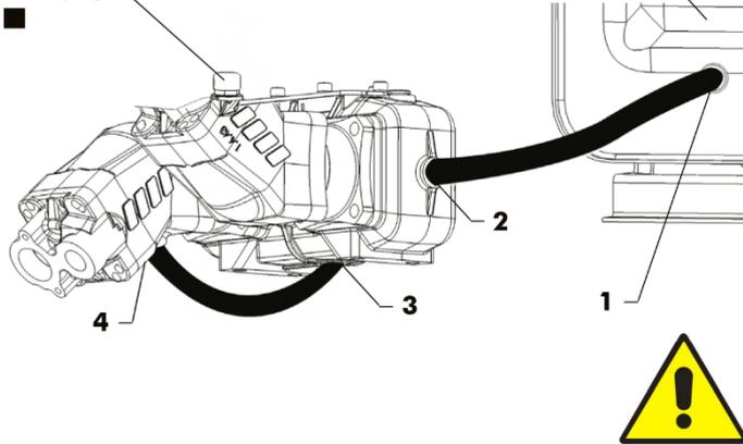
Collegare l'uscita del serbatoio 1 all'ingresso 2 dello Splitterbox.
