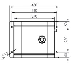
**11800600102 : TAPPO / CAP** Già compreso nel serbatoio. Solo per ricambi Already included with the tank. Only for spare part
