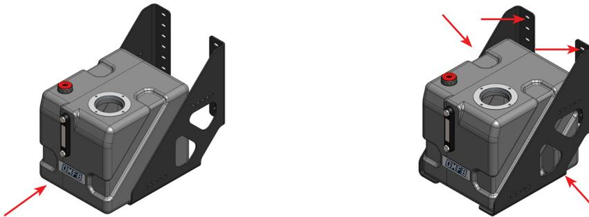
Sfilare il serbatoio e serrare tutte le viti di fissaggio dei supporti a telaio.
