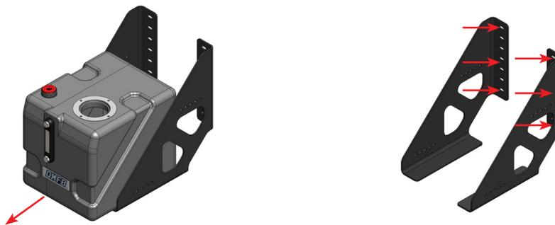
Infilare nuovamente il serbatoio e serrare le 4 viti di fissaggio (comprese nel kit) del serbatoio con una coppia massima di 18 Nm (accertarsi che le viti di fissaggio non deformino il serbatoio).
