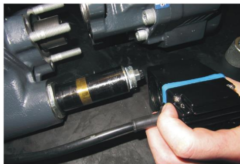
Estrarre la bobina dal canotto. Take out the coil from the cylinder.
